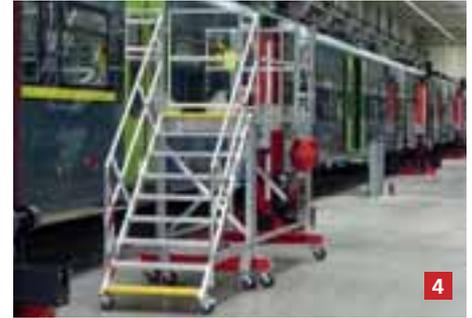
4. Mobile Seitenarbeitsbühne zum Bearbeiten der unteren Seitenbereiche
