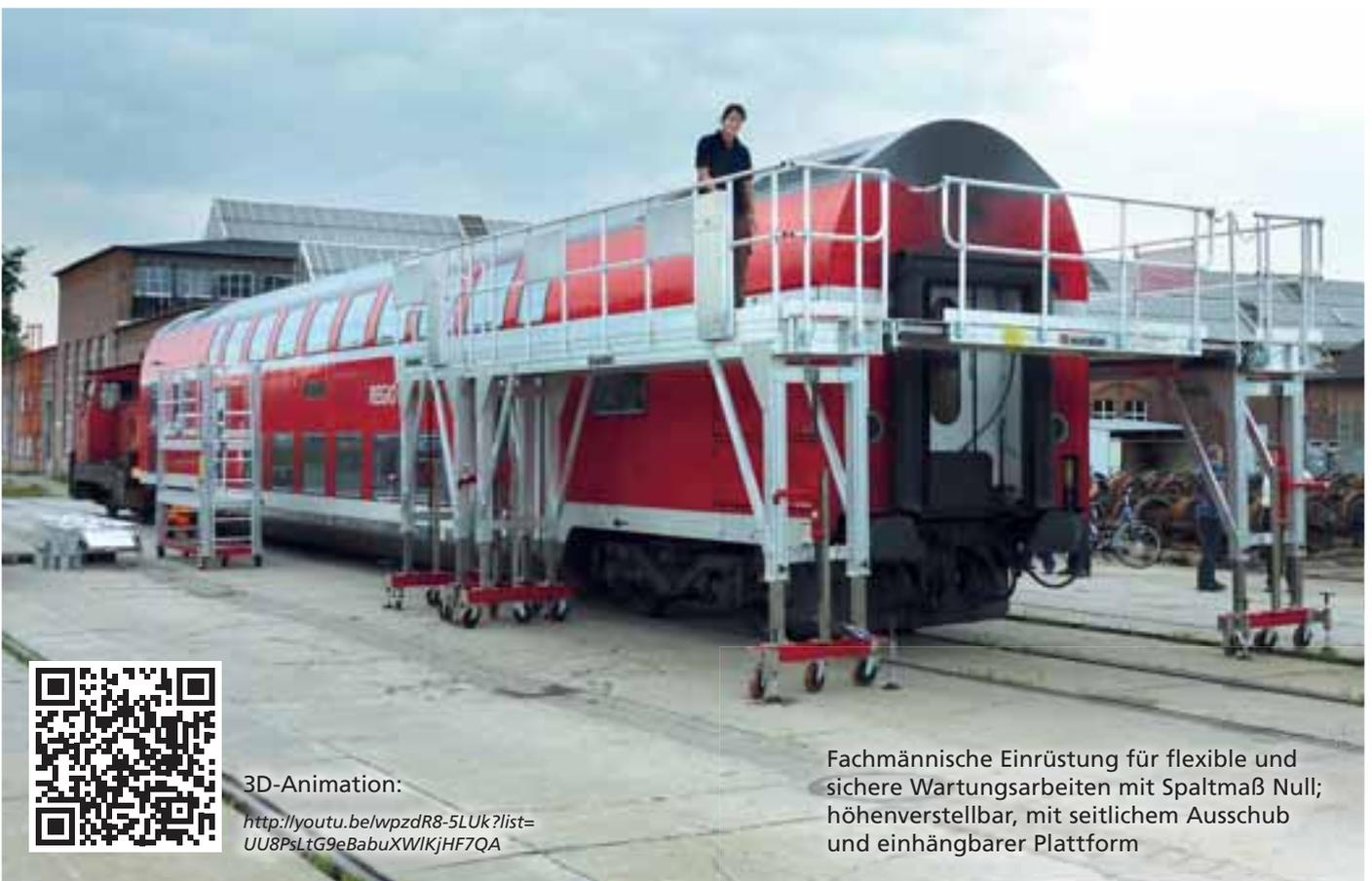
Fachmännische Einrichtung für flexible und sichere Wartungsarbeiten mit Spaltmaß Null; höhenverstellbar, mit seitlichem Ausschub und einhängbarer Plattform
