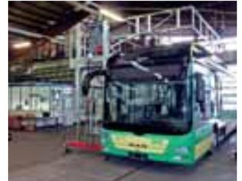
Robuste Einhausung: Mit Ausklappgeländer für zusätzlichen Schutz
