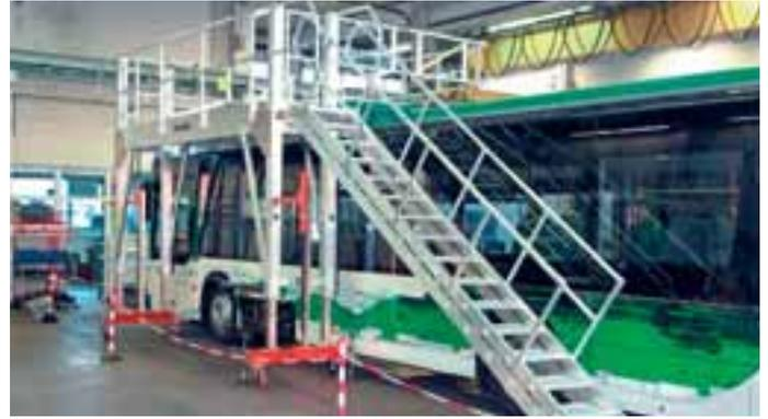
Für den komfortablen Zugang zu unterschiedlichen Höhen – die Vario-Treppe
